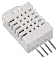
รูปที่ 4.11 เซนเซอร์วัดอุณหภูมิและความชื้น
