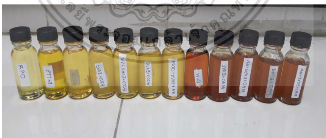
รูปที่ 4.15 น้ำมันไฮดรอลิกที่พัฒนาจากน้ำมันปาล์มกลั่นบริสุทธิ์ใช้แล้วหรือ DUPH
