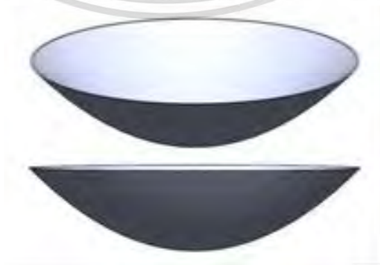
รูปที่ 4.1 จานรวมแสงพาราโบลา ที่วาดด้วยโปรแกรม Comsol multiphysics
