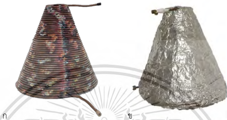
รูปที่ 4.16 ก) แสดงตัวรับแสงอาทิตย์ที่ทำจากท่อทองแดง ข) ตัวรับแสงอาทิตย์ที่ทำจากท่อทองแดงหุ้มด้วยฉนวนและพอยด์กันความร้อน
