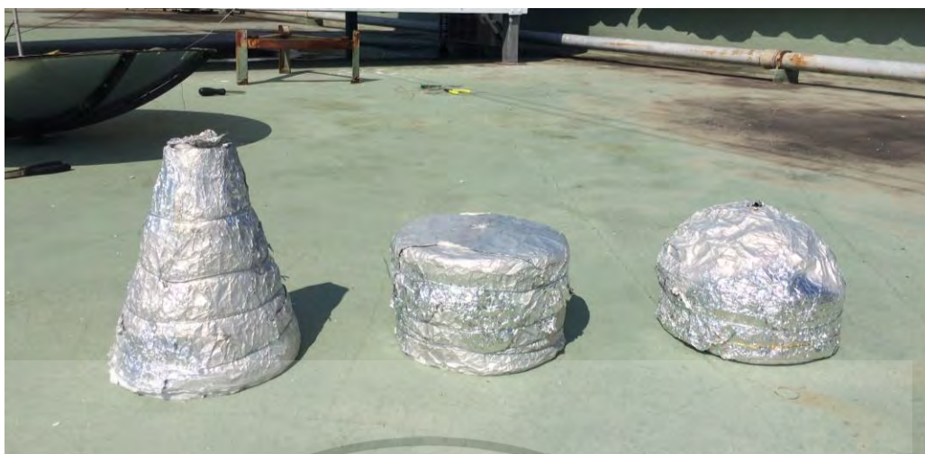
รูปที่ 4.6 แสดงตัวรับแสงอาทิตย์สำหรับจานรวมแสงอาทิตย์ขนาดเล็กที่ใช้มี 3 รูปทรง ได้แก่ รูปทรงกรวย รูปทรงกระบอก และรูปทรงโดม
