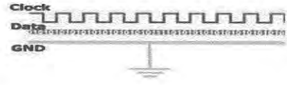
รูปที่ 1 การสื่อสารอนุกรมแบบ Synchronous
