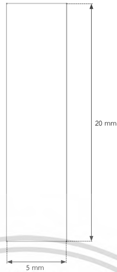
รูปที่ 3.16 รายละเอียดขนาดของชิ้นส่วนที่เชื่อมต่อกับตัวต่อของสายโคแอกเซียลบริเวณ ชั้นที่ 5 และ 6 (ด้านซ้าย)
