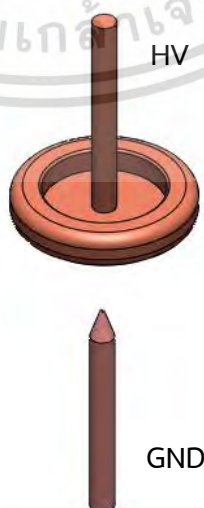
รูปที่ 2.1 การเกิดดิสชาร์จแบบโคโรน่า
