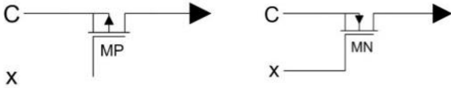
รูปที่ 3.1 วงจร pass-transistor สำหรับการดำเนินการ C * x' และ C * 'x
