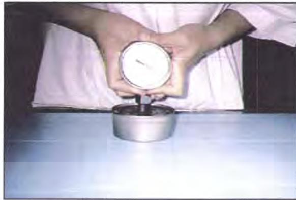
ภาพที่ 9 การวัดค่าความเป็นสุญญากาศของแก๊ซเหล็กใต้น้ำนมถั่วเหลืองบรรจุกระป๋อง
