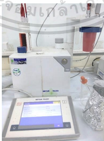
ภาพที่ 3.18 การวิเคราะห์วิตามินซีด้วยเครื่องไตเตรทอัตโนมัติ
