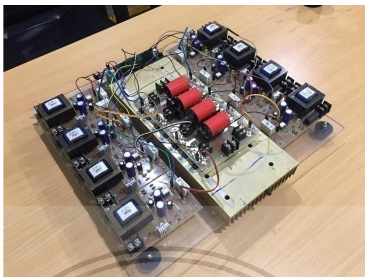
รูปที่ 4.5 อุปกรณ์จริงของวงจรคอนเวอร์เตอร์หลายระดับไดโอดแคลมป์แบบ 5 ระดับ
