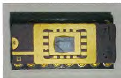
รูปที่ 3.3 ลักษณะชิ้นงานที่ผ่านการตัดแยกชิ้นและเชื่อมต่อขา
