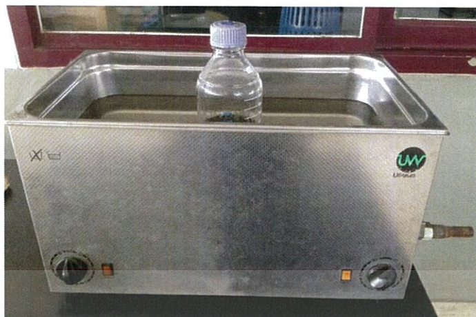
รูปที่ 3.6 เครื่องโซนิเคเตอร์ (Ultrasonic Bath)
