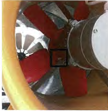
รูปที่ 3ค ตำแหน่งที่ใช้ในการวัดความเร็วรอบของพัดลม
