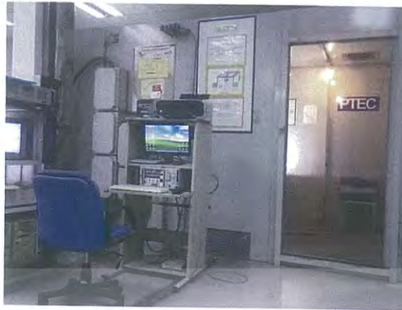
รูปที่ 3.12 ห้องทดลองวัดสัญญาณรบกวนทางแม่เหล็กไฟฟ้า หรือ EMI ผ่านทางตัวนำจาก ศูนย์ทดสอบผลิตภัณฑ์ไฟฟ้า และอิเล็กทรอนิกส์ หรือ PTEC
