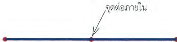
รูปที่ 3.2 แสดงเอลิเมนต์มิติเดียวที่ประกอบด้วยจุดต่อที่ปลายทั้งสองด้านของแต่ละเอลิเมนต์
