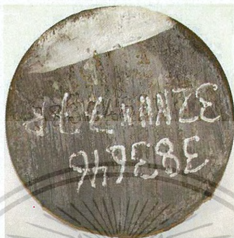
รูปที่ 4.10 ตัวอย่างแผ่นเหล็กที่ประทับตัวเลขรอยนูนบนพื้นผิวที่ไม่เรียบ
