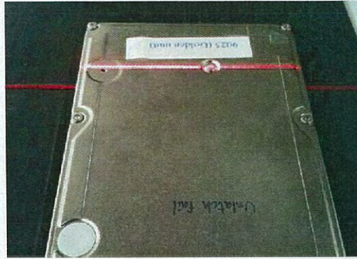
รูปที่ 4.16 เส้นแสงเลเซอร์สีแดงบนตัวเรือนของฮาร์ดดิสก์ไดร์ฟ
