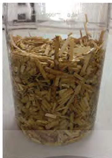
รูปที่ 3.1 การตัดแปลงสภาพฟางข้าวด้วยการแช่ในน้ำ
