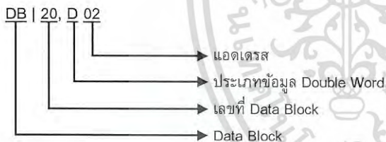
รูปที่ 6 รูปแบบการสื่อสารระหว่าง OPC กับ S7-300
