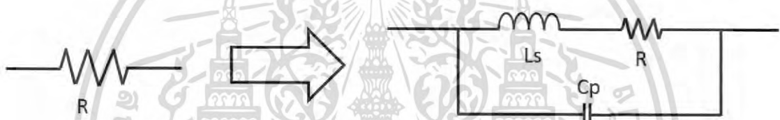
รูปที่ 2.30 ตัวต้านทานไฟฟ้าในทางอุดมคติและเมื่อมีองค์ประกอบแฝงในทางปฏิบัติ
