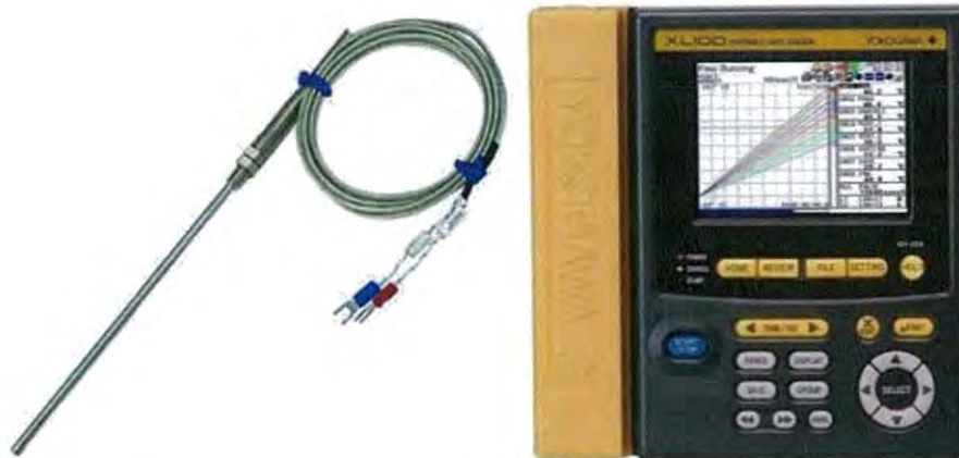
รูปที่ 5.21 thermocouple type K และหน่วยแสดงผล YOKOGAWA XL 100
