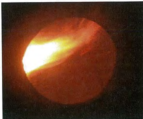
รูปที่ 6.8 แสดงลักษณะการลอยตัวของเปลวไฟในช่วงที่เริ่มการปล่อยอนุภาคเชื้อเพลิงผง
