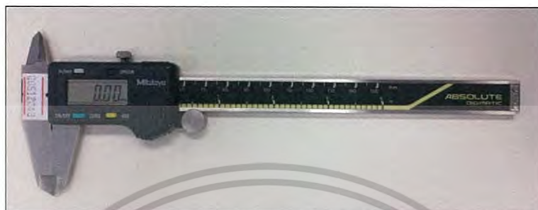
ภาพที่ 3.4 เครื่องมือวัดขนาดของชิ้นงานแบบดิจิทัลของ Mitutoyo รุ่น ABSOLUTE DIGIMATIC
