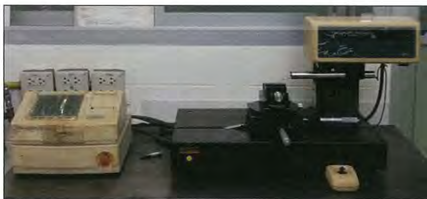
ภาพที่ 3.3 เครื่องวัดความหยาบผิว TOKYO SEIMITSU รุ่น SURFCOM 480A
