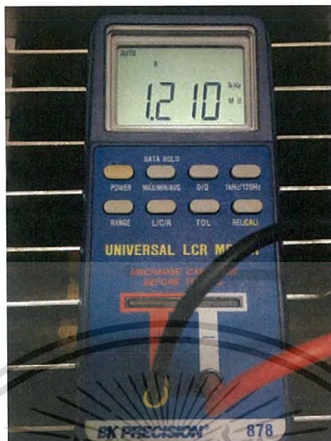
รูปที่ 4.10 ค่าความต้านทานของอิเล็กทรอนิกส์กระตุ้นเมลิ็ดพันธ์ข้าวขณะบรรจุข้าวครึ่งหนึ่ง
