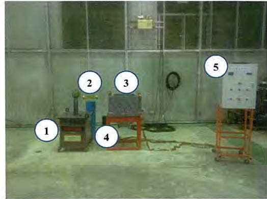
รูปที่ 5 การทดสอบการทำงานร่วมกันระหว่างชุดต้นแบบเครื่องกระตุ้น แม่เหล็กพันรู้ซ้ำกับชุดควบคุมเครื่องกระตุ้นแม่เหล็กพันรู้ซ้ำ
