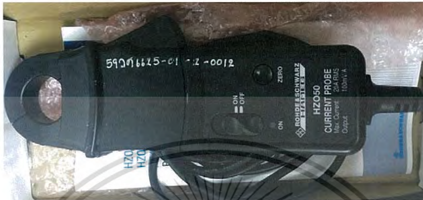
รูป Current Probe รุ่น HZO50 มีอัตราส่วนการวัดอยู่ที่ 100 mV / A
