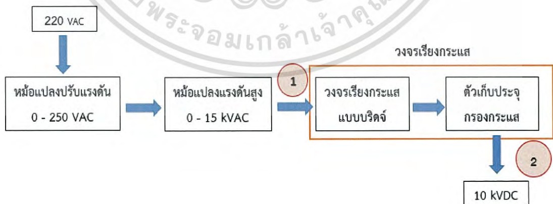
รูปที่ 4.2 จุดวัดรูปคลื่นแรงดันไฟฟ้าของชุดจ่ายแรงดันไฟฟ้ากระแสตรง
