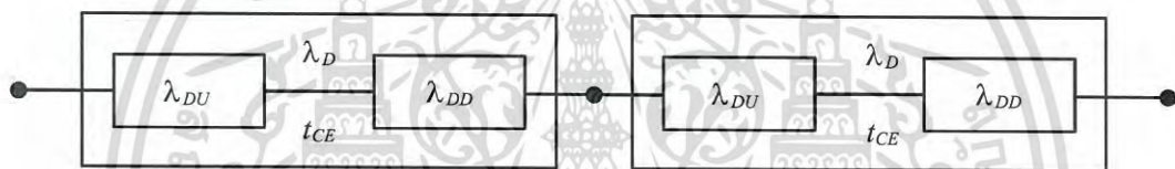
รูปที่ 2.8 บล็อกไดอะแกรมความน่าเชื่อถือของการจัดวางแบบ 2o02
