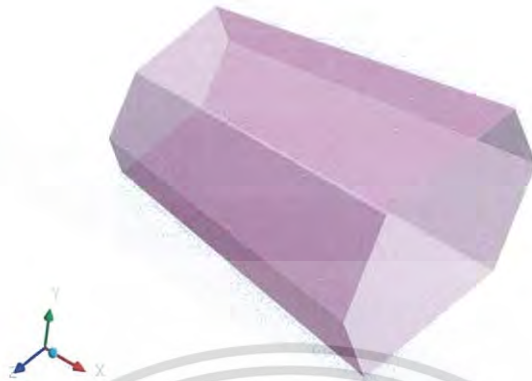
รูปที่ 5.11 ท่อกลมที่ใส่แหวนทรงกรวยหกเหลี่ยมปรับปรุงแบบที่ 1
