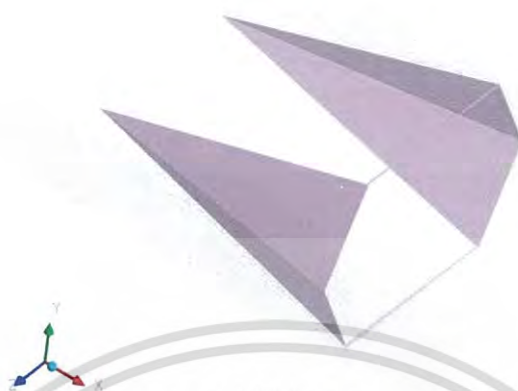
รูปที่ 5.21 รูปทรงของท่อกลมที่ใส่แหวนทรงกรวยทรงหกเหลี่ยมปรับปรุงแบบที่ 2
