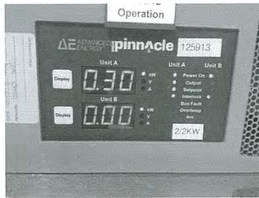
รูปที่ 7จอแสดงเอาต์พุตของแรงดัน กระแส และกำลังไฟฟ้าขณะสับเตออร์
