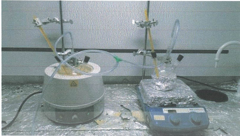
ภาพที่ 3.2 การสังเคราะห์สารควอนตัมดอท PbS ด้วยวิธีการฉีดร้อน
