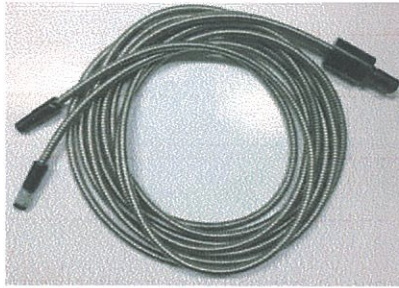
ภาพที่ 3.8 สายใยแก้วนำแสงสำหรับนำส่งแสงจากแหล่งกำเนิดแสงไปยังแผ่นรวมแสง
