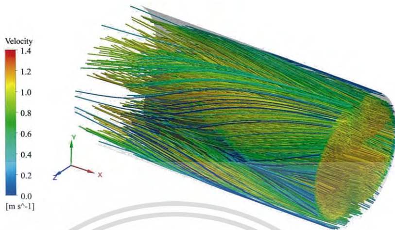
รูปที่ 5.32 เส้นกระแสการไหลแบบ 3 มิติเมื่อใส่แหวนทรงกรวยแบบปรับปรุง 3 ( \alpha_2=17^\circ )
