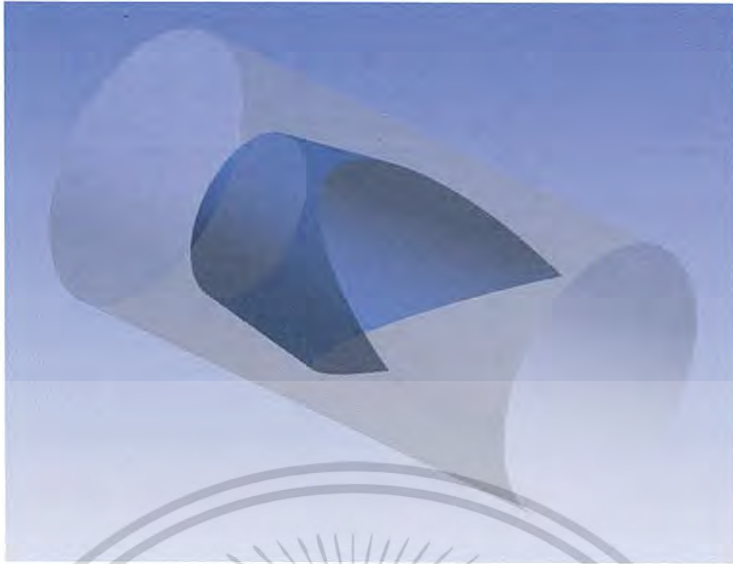
รูปที่ 4.6 ภาพ 3 มิติของท่อกลมที่ใส่แหวนทรงกรวยแบบปรับปรุง 3 (รูปตัววีด้านหลัง)
