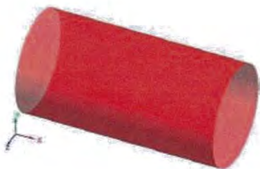
รูปที่ 5 การกระจายอุณหภูมิที่บริเวณผนังท่อกลมที่ไม่มีการติดตั้งแหวนทรงกรวย
