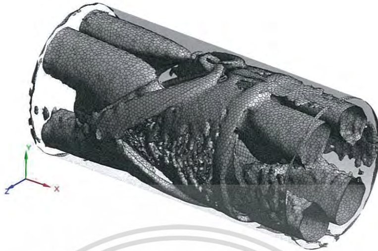
รูปที่ 5.23 โครงสร้างการไหลเมื่อใส่แหวนทรงกรวยแบบปรับปรุง 2 ( \alpha_1=30^\circ ) โดยแสดงในรูปของ core of vortex
