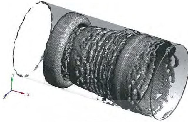
รูปที่ 5.4 โครงสร้างการไหลเมื่อใส่แหวนทรงกรวยแบบดั้งเดิมที่แสดงในรูปของ core of vortex
