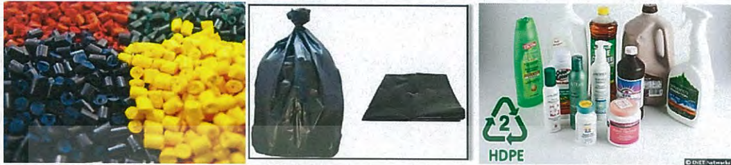
รูปที่ 2.3 ตัวอย่างเม็ดพลาสติกสี และสินค้าที่ผลิตจากเม็ดพลาสติกสี
