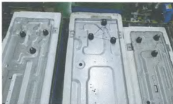
ภาพที่ 3.30 ความแตกต่างของทิศการวางตัว Grommet บน Base-Out
