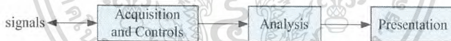
ภาพที่ 2.44 Block Diagram เครื่องมือวัดที่สร้างจาก LabVIEW
