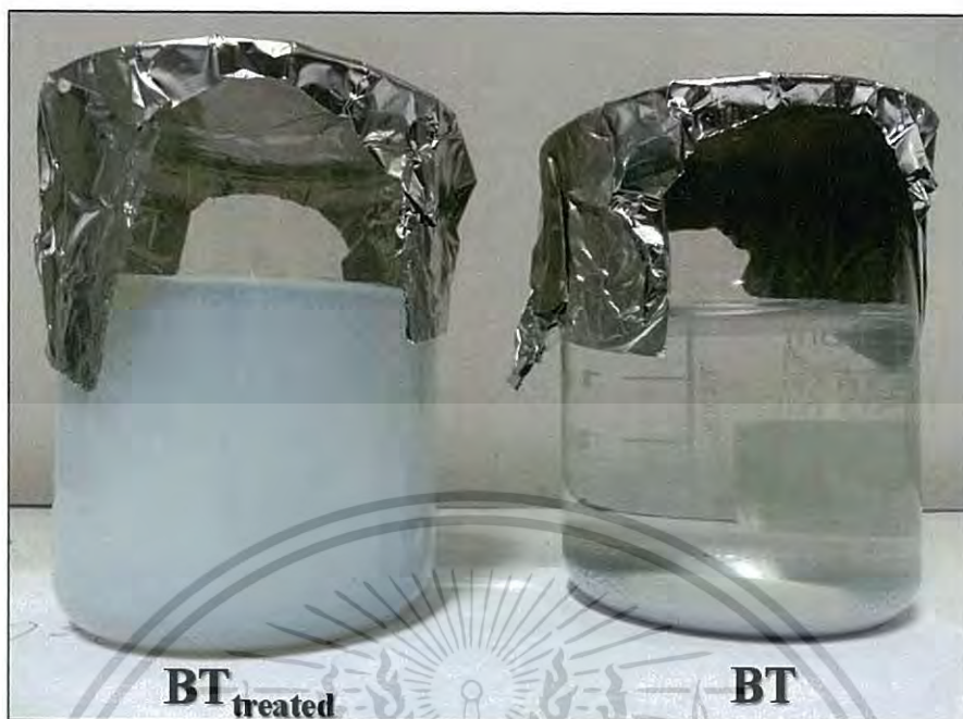
รูปที่ 4.17 รูปแสดงผลการการโซโนเคมีกับ PDADMAC ของอนุภาคแบเรียมไททาเนตที่มีการปรับปรุงพื้นผิว ( BT_{treated} ) และอนุภาคแบเรียมไททาเนตที่ไม่มีการปรับปรุงพื้นผิว (BT)
