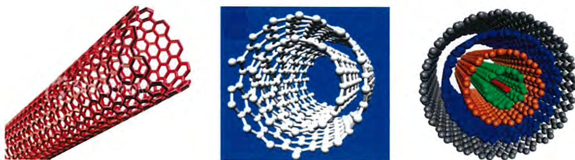
รูปที่ 2.16 รูปแบบการสังเคราะห์ท่อคาร์บอน ท่อคาร์บอนผนังเดี่ยว (Single-walled nanotube; SWNT) ท่อคาร์บอนผนังคู่ (Double-walled-nanotube; DWNT) และ ท่อคาร์บอนหลายผนัง (Multiple-walled nanotube; MWNT) [19]
