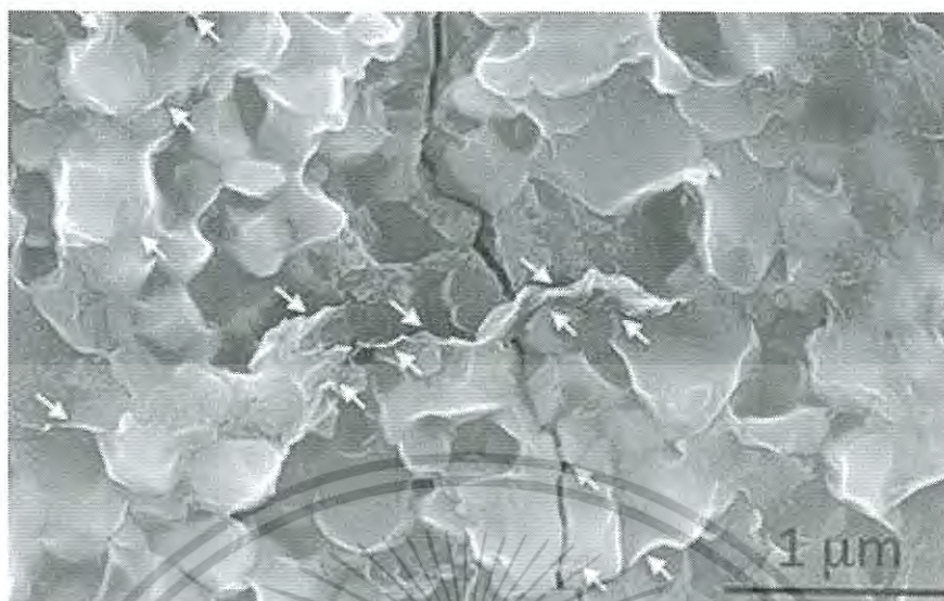
รูปที่ 2.7 แสดงเกรนและขอบเขตรอยต่อของเกรน
