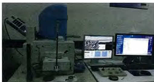
รูปที่ 3.2 ภาพถ่ายอุปกรณ์กล้องจุลทรรศน์อิเล็กตรอนแบบส่องกราดรุ่น FESEM-EDS (7610F)
