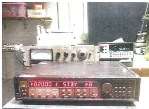
รูปที่ 3.7 ภาพถ่ายอุปกรณ์ที่ใช้วัดปรากฏการณ์ฮอลล์
