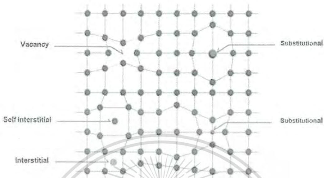
รูปที่ 2.5 แสดงข้อบกพร่องผลึกแบบจุดชนิดต่างๆ
