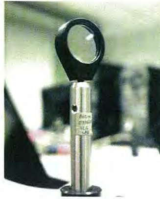
รูปที่ 3.2 เลนส์นูนที่ใช้ในการรวมแสงเลเซอร์ และขยายลำแสงในการบันทึกภาพโฮโลแกรม
