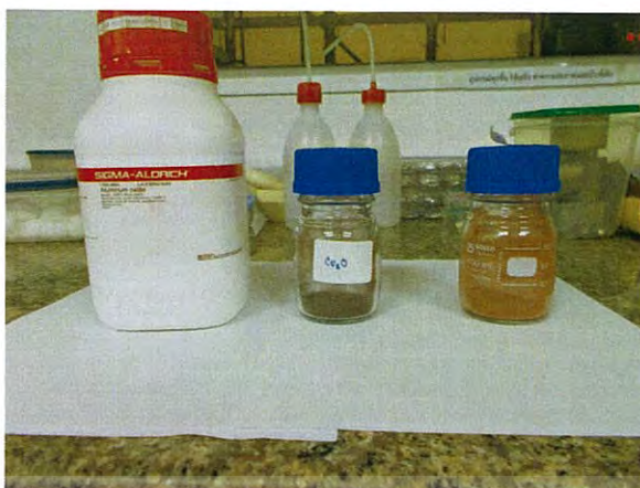
รูปที่ 3.5 สารที่ใช้ในการทำชิ้นงาน \text{Al}_2\text{O}_3 , \text{Cu}_2\text{O} , \text{Fe}_2\text{O}_3
