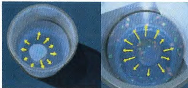
รูปที่ 2.17 รังสีที่ปล่อยออกมาทำให้ solvent อยู่ในสถานะ excitation หลังจากถ่ายเทพลังงานให้ flour จะเกิดการเรืองแสงขึ้น
