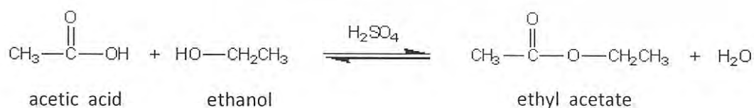
รูปที่ 2.5 ปฏิกิริยาระหว่างกรดแอสติกกับเอทานอล
