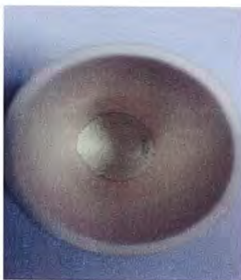
รูปที่ 3.7 แสดงสีของผงผลึกของสารประกอบ \text{NaIn}_{0.96}\text{Tb}_{0.04}(\text{WO}_4)_2 เมื่อเผาที่อุณหภูมิ 700 องศาเซลเซียส เป็นเวลา 24 ชั่วโมง
