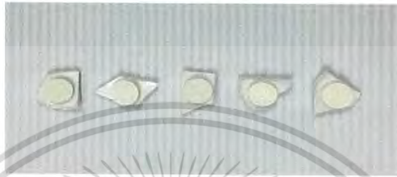
รูปที่ 3.3 แสดงสีของเม็ดเซรามิกของสารประกอบ \text{NaIn}_{1-x}\text{Eu}_x(\text{WO}_4)_2 ( 0.00 \leq x \leq 0.10 ) เมื่อเผาที่อุณหภูมิ 700 องศาเซลเซียส เป็นเวลา 24 ชั่วโมง
