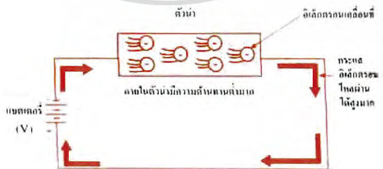
รูปที่ 2.19 แสดงการไหลของกระแสอิเล็กทรอนิกส์ในตัวนำ
