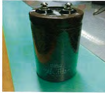
รูปที่ 3.4 แสดงตัวเก็บประจุขนาด CE 85°C 4000uF 400WV
