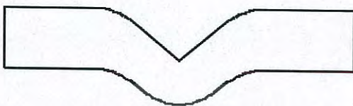
รูปที่ 3.3 ตัวอย่างชิ้นงานทดสอบค่าความแข็งแรงฉีกขาด [35]
