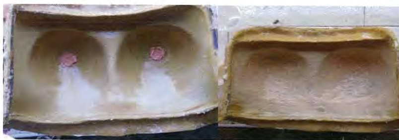
รูปที่ 3.5 การทายางซิลิโคนที่แม่พิมพ์แบบจำลองมะเร็งเต้านม
