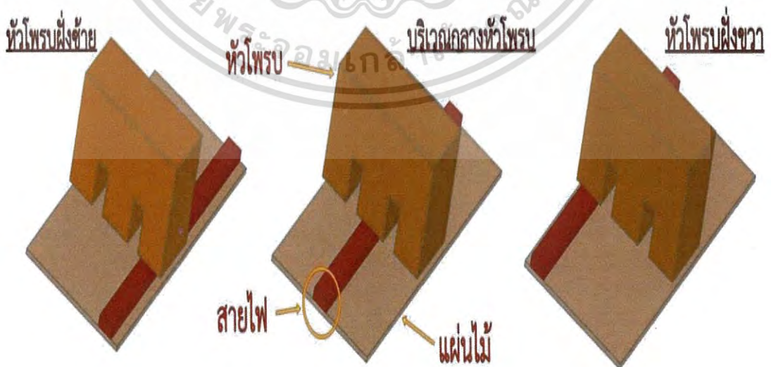
รูปที่ 3.17 การลองการวางหัวโพรบแต่ละตำแหน่งบนสายไฟ
