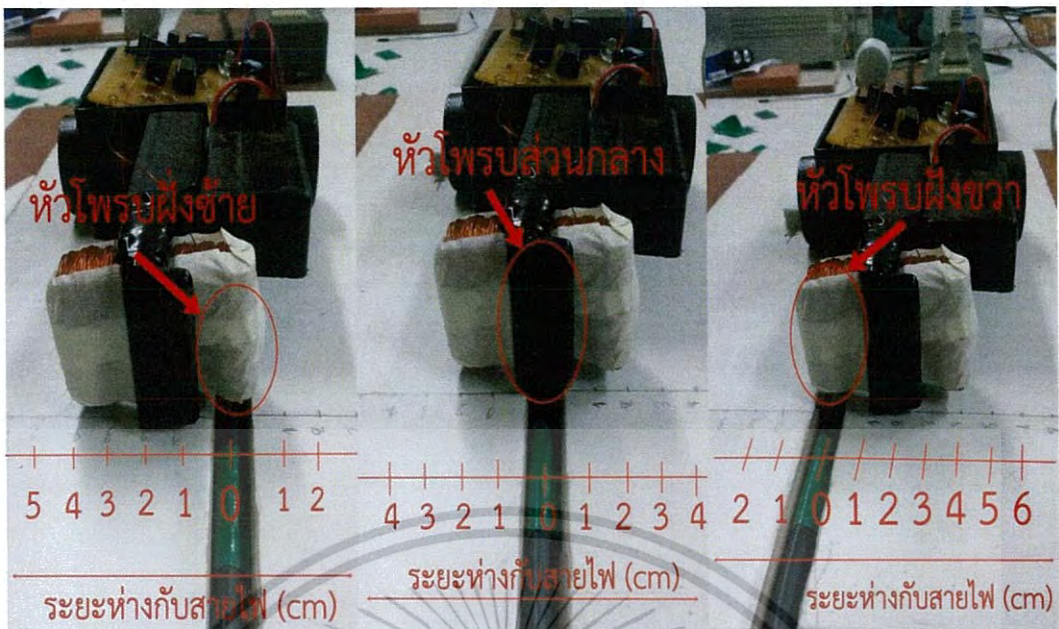
รูปที่ 3.18 การวางหัวโพรบแต่ละตำแหน่งในระยะห่างสายไฟ 0 ซม.
