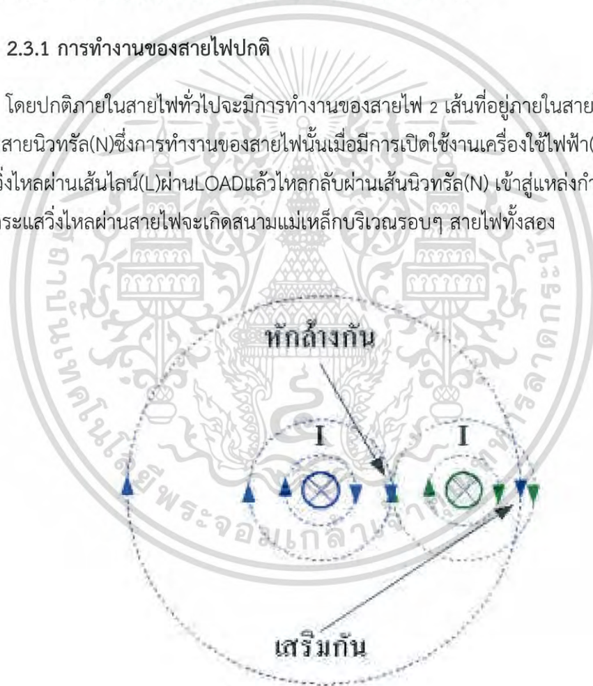
รูปที่ 2.5 ลักษณะการกระจายสนามแม่เหล็กที่เกิดขึ้นรอบ ๆ คู่สายไฟปกติ
