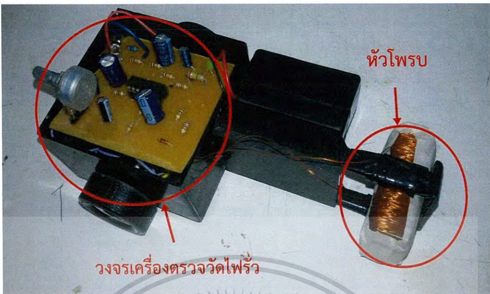
รูปที่ 3.11 หัวโพรบที่ต่อเข้ากับวงจรเครื่องตรวจวัดไฟรั่ว
