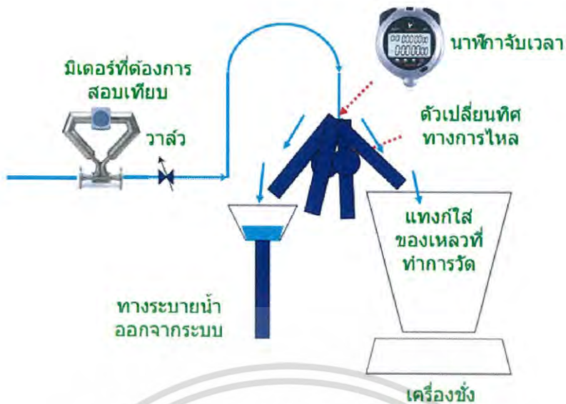
ภาพที่ 2.36 การสอบเทียบมิเตอร์วัดการไหลโคริออลิส
