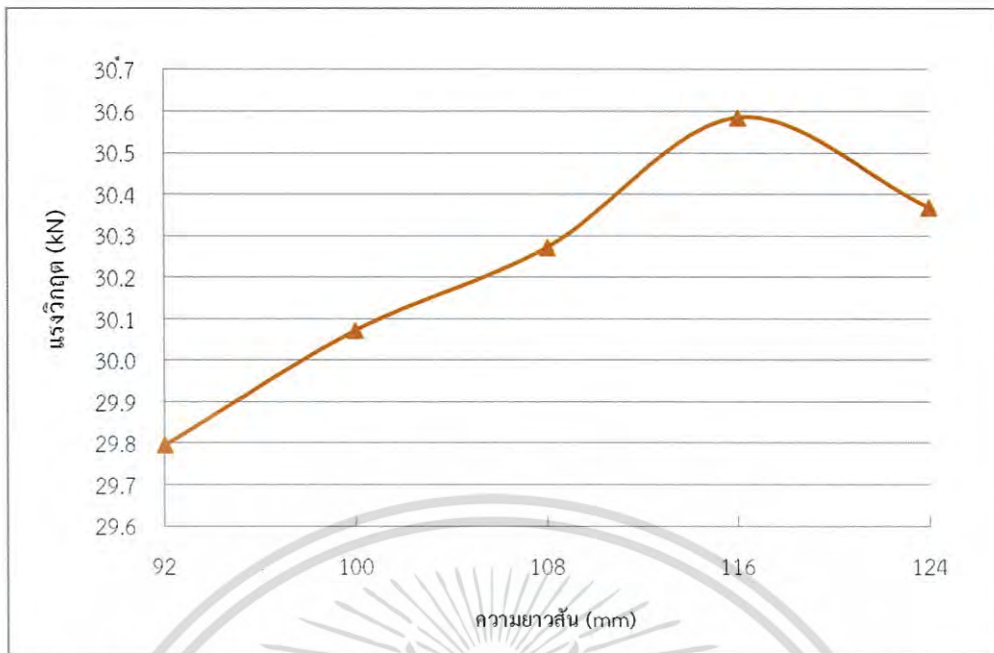
รูปที่ 5.41 แสดงแรงสูงสุดที่ทำให้เกิดการโก่งเดาะของการปรับระยะความยาวสัน
