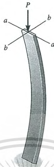
รูปที่ 3.17 เสาที่มีหน้าตัดรูปสี่เหลี่ยมผืนผ้า
