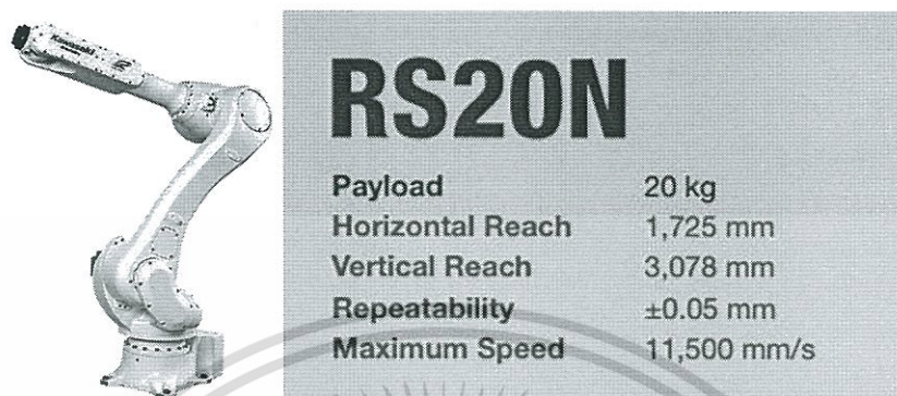
รูปที่ 2.11 ภาพคุณสมบัติของหุ่นยนต์ Kawasaki RS020N
