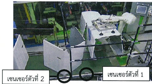
รูปที่ 4.5 ตำแหน่งที่ติดเซนเซอร์สำหรับตรวจสอบว่ามีชิ้นงานบนสายพานหรือไม่
