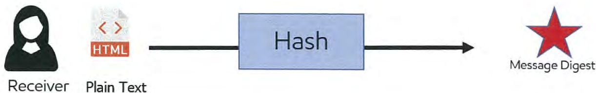
ภาพที่ 3.11 ผู้รับนำข้อความต้นฉบับมาแฮชจะได้ข้อความไคเจส
