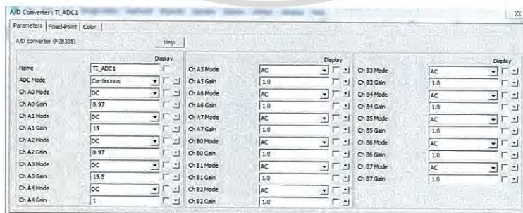
ภาพที่ 3.70 แสดงการปรับค่า Gain ขดเชย ADC ใน A/D Converter block Ti-F28335
