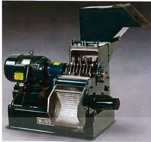
ภาพที่ 2.3 ตัวอย่างเครื่องบดแบบค้อนเหวี่ยง
