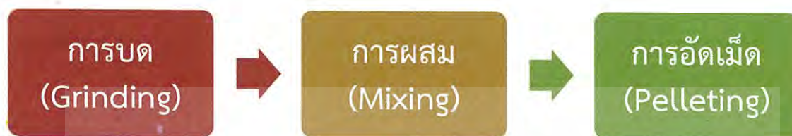
ภาพที่ 2.2 กระบวนการผลิตอาหารสัตว์อัดเม็ด
