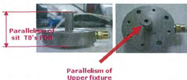
รูปที่ 3.61 กำหนดฟิกเจอร์ด้านบนควบคุมค่าความขนาน 0.002 mm
