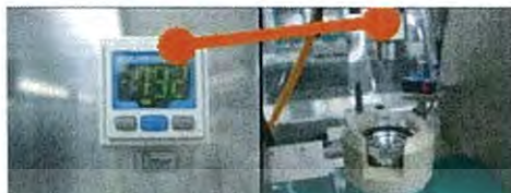
รูปที่ 3.47 แรงลมดูดของฟิกเจอร์ด้านบน (Vacuum pressure of Upper fixture)
