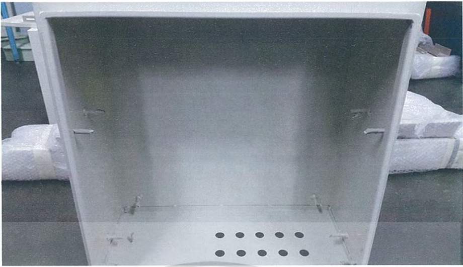
รูปที่ 3.17 ตู้ Control หลังทำสี
