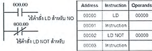
รูปที่ 2.33 ชุดคำสั่งและการเขียน Ladder Diagram คำสั่ง LD และ LD NOT
