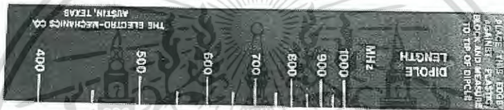
รูปที่ 4.4 ไม้บรรทัดปรับระยะความยาวสายอากาศตามความถี่
