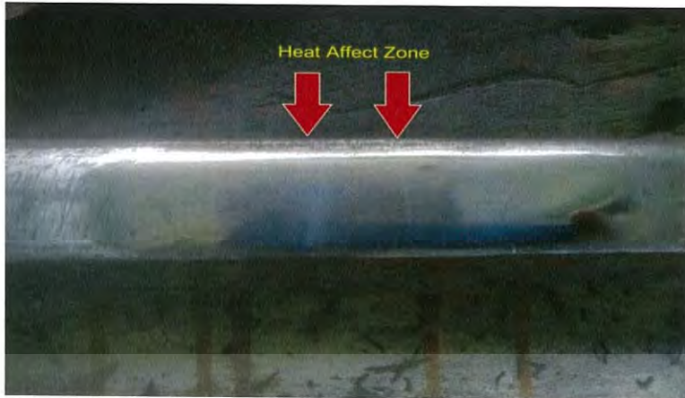
ภาพที่ 7.3 แสดงลักษณะและขนาดของผลกระทบเนื่องจากความร้อนหลังการขัดด้วยกระดาษทรายแล้วทาด้วยกรดไนตรอน 10 %
