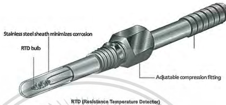
รูปที่ 2.2 โครงสร้าง RTD
